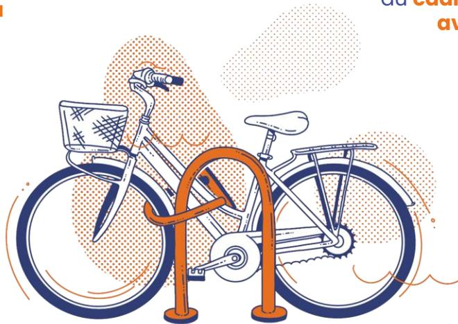
Support permettant de **stabiliser l'entièreté du vélo** par appui ou maintien du cadre
