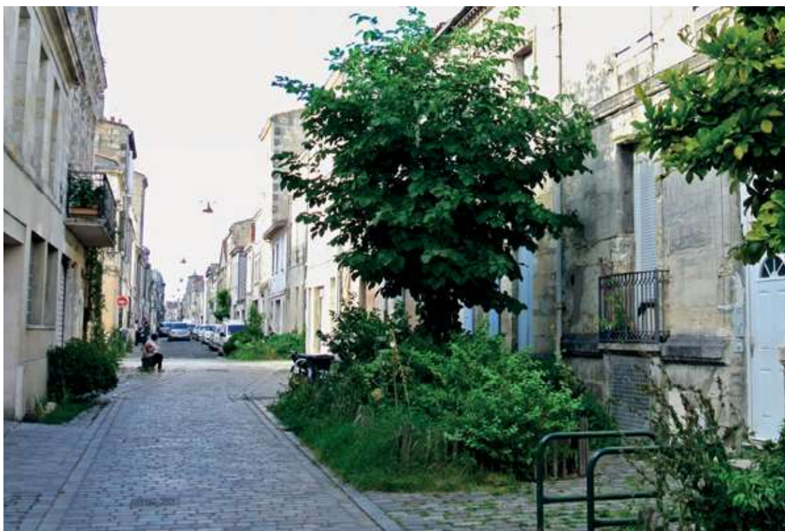
La végétation est utilisée abondamment afin de réduire l'emprise et de modifier la perspective. L'installation de mobilier urbain en entrée de zone de rencontre montre à l'automobiliste qu'il se trouve dans une rue où la vie locale est très présente.
